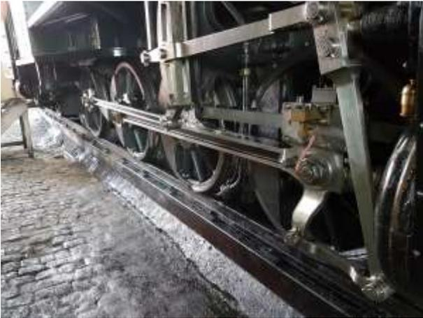
Kuppelstangen einer G 4/5-Dampflokomotive der Rhätischen Bahn, Baujahre 1904-1915 (Schweizerischen Lokomotiv- und Maschinenfabrik). Foto aus der RhB-Hauptwerkstätte Landquart, 12.9.2017.
