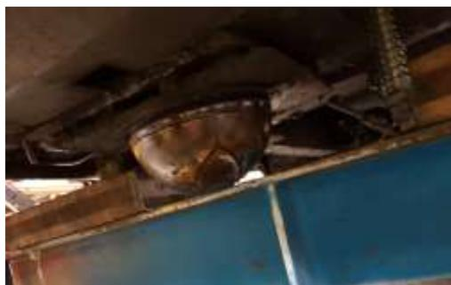
Gelenkkugel, die den Hauptkasten von Lok 415 mit einer der Vorbauten verbindet. Foto aus der RhB-Hauptwerkstätte Landquart.
