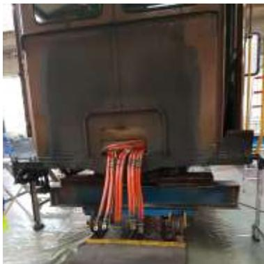
Stromkabel vom Mittelkasten mit dem Lok-Transformator zum Fahrmotor in einem der Triebsätze. Hier fließen Ströme von 1600 Watt! Ge 6/6 I Nr. 415 in der RhB-Hauptwerkstätte Landquart, 12.9.2017.
